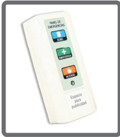
Se trata de un dispositivo electrónico que contiene un comunicador digital preparado para transmitir emergencias por línea telefónica.
